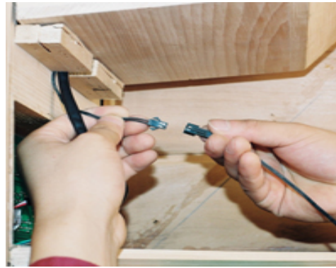
FIG-19 Verbind de temperatuurvoeler
